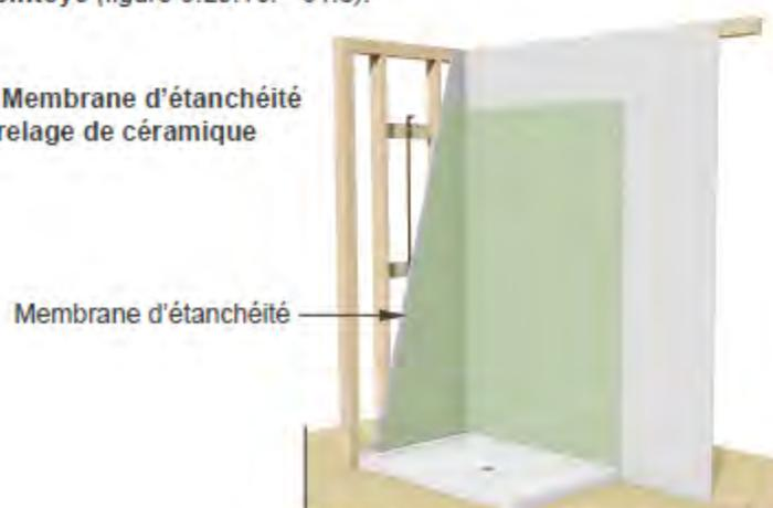
Il est important que le joint entre la base de douche et le revêtement de céramique soit souple. Il est donc nécessaire d'appliquer un joint de scellant au lieu d'un joint de coulis à cet endroit afin de permettre au joint de conserver son intégrité et son efficacité même s'il y a de légers mouvements au niveau de la base de douche (figure 9.29.10. - 01.4).
