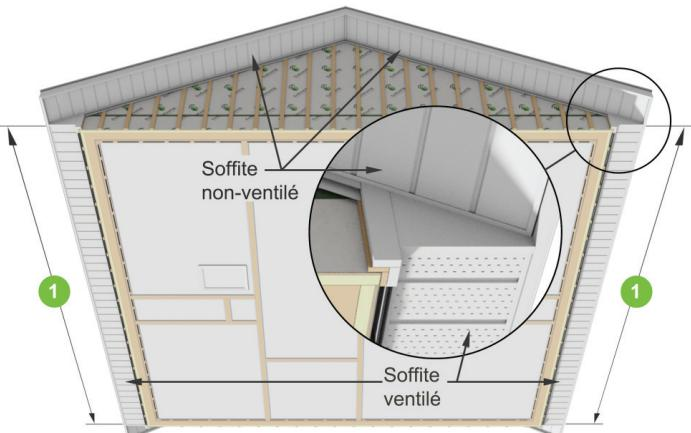
Avec un soffite dont l'efficacité est de 2% par m<sup>2</sup>, soit 0,02 m<sup>2</sup> de ventilation effective, cela offre exactement la surface de ventilation minimale nette de 0,183 m<sup>2</sup> recommandée et qui est bien au-delà de la surface minimale exigée de 25% qui représenterait 0,083 m<sup>2</sup>.
