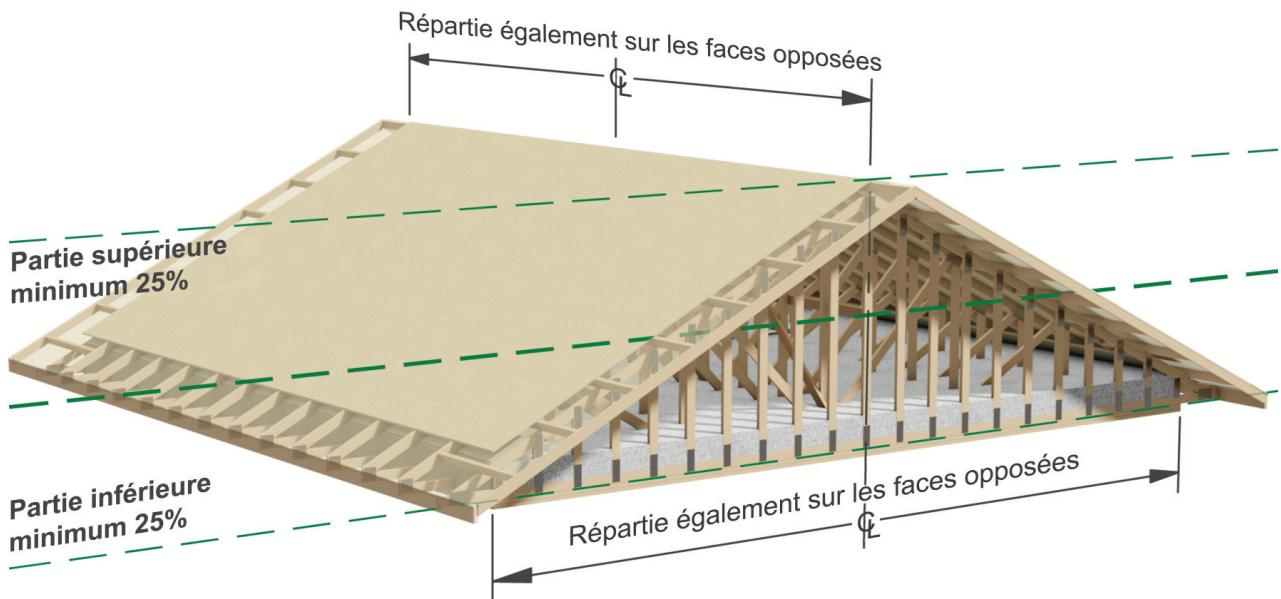
Selon le **Guide illustré CNB 2015**, la configuration la plus efficace est constituée de dispositifs de ventilation **le long du faîteage combinés à une ouverture continue dans l'avant-toit**.
