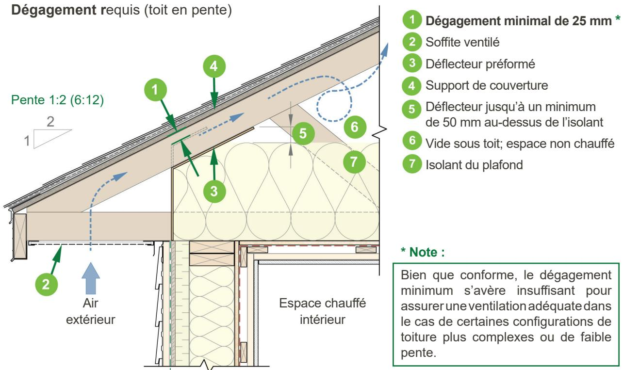
Il faut toutefois prévoir un dégagement de 63 mm entre le dessus de l'isolant et la sous-face du support de couverture pour une toiture de type cathédrale [référence **paragraphe 9.19.1.3. 1**) du Code] (*figure 9.19. - 01.4 et figure 9.19. - 01.5*).
