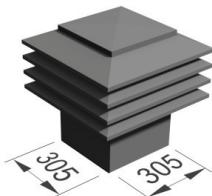
**Note :** Pour les fins de calculs la surface utilisée est de 0,093 m<sup>2</sup>, ce qui représente l'ouverture nette avec le vide sous toit. Toutefois, le ventilateur à ailettes (actif) offre sous l'effet du vent, un effet d'aspiration qui augmente son efficacité de façon notable (voir les spécifications des manufacturiers).
