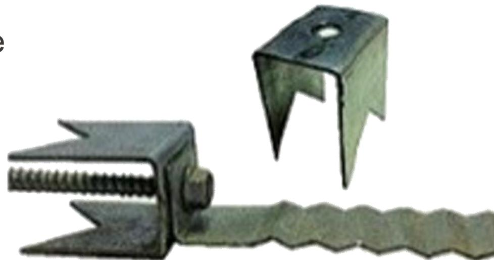
*Par contre, une vérification de la performance en service de ce type de produit est à faire. L'IMQ se questionne principalement sur l'effet de l'extrémité pointue de l'espaceur qui pourrait potentiellement s'enfoncer dans le revêtement intermédiaire. De plus, ce type de produit exigera une installation bien centré sur le montant pour s'assurer d'un appui équivalent pour toutes les pointes.*
