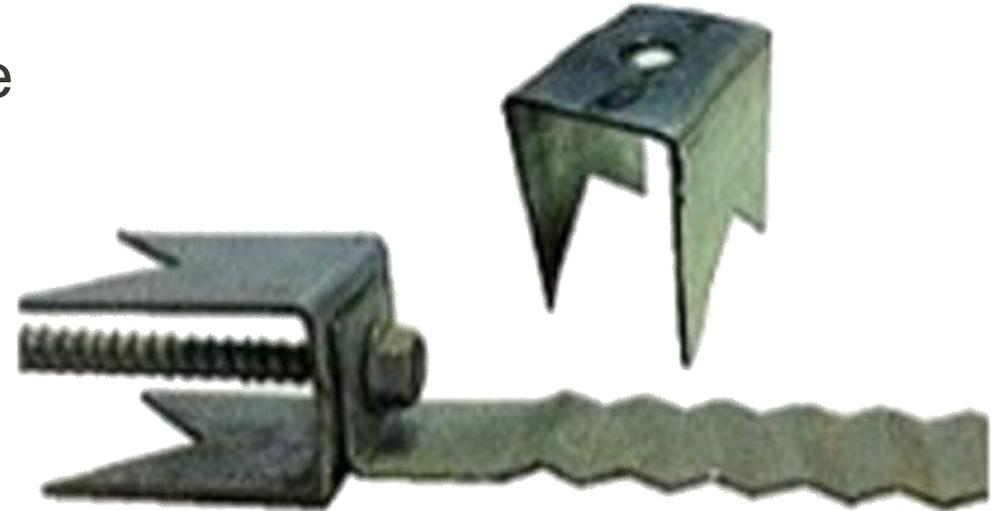
*Par contre, une vérification de la performance en service de ce type de produit est à faire. L'IMQ se questionne principalement sur l'effet de l'extrémité pointue de l'espaceur qui pourrait potentiellement s'enfoncer dans le revêtement intermédiaire. De plus, ce type de produit exigera une installation bien centré sur le montant pour s'assurer d'un appui équivalent pour toutes les pointes.*
